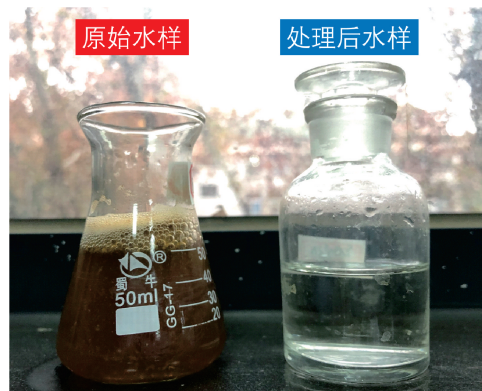
图8 处理前、后石油废水外观对比
